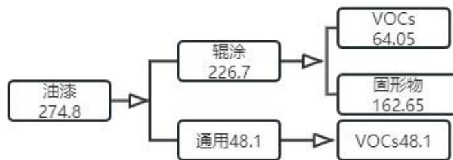
图4.4-1 油漆物料平衡图 单位：kg/支
